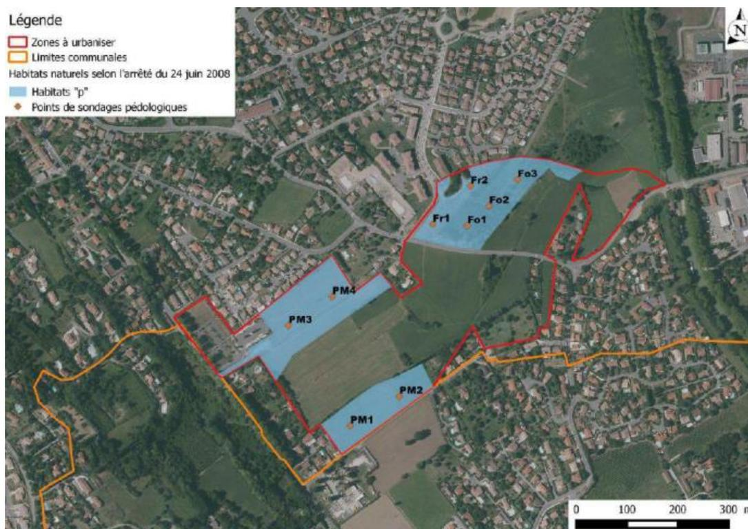
Figure 83 - LOCALISATION DES SONDRAGES PEDOLOGIQUES REALISES POUR VERIFIER LE CARACTERE HUMIDE DES HABITATS « P » SUR LA ZONE D'ETUDE – SOURCE : IDE ENVIRONNEMENT 2015
