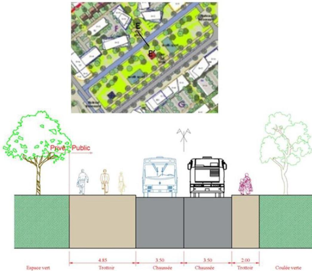
Figure n° 74 : Coupe ne travers de la voie TCSP
