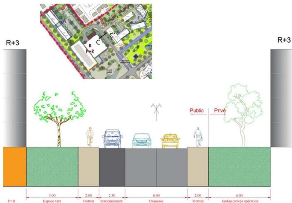
Figure n° 60 : Coupe en travers de la voie d'accès au P + R
