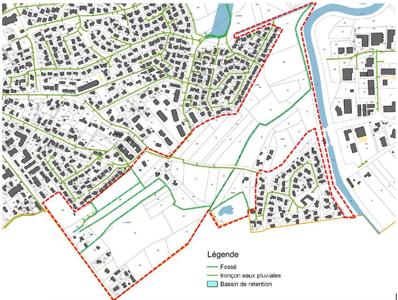
Cartographie des réseaux d'eaux pluviales 2017 – Source : Sicoval
